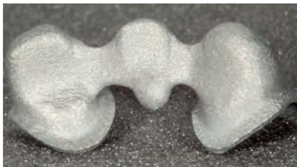
Laserovým sintrovaním je možné vyrobiť akékoľvek tvary, ktoré si navrhnete
